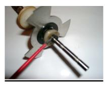
Entfernen sie die beiden ← Sicherungsringe der Welle.
