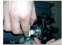
Schrauben sie das Rückwandgehäuse ab (3 Schrauben).
